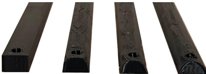
Рисунок 5.6 – Образцы изношенных футеровок барабанной шаровой мельницы
