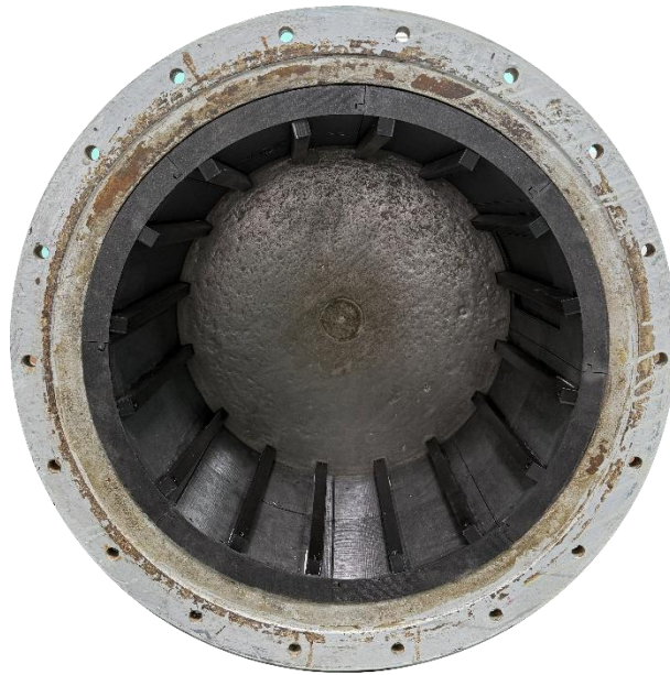
Рисунок 4.3 – Футеровка, установленная в корпусе лабораторной барабанной шаровой мельницы
