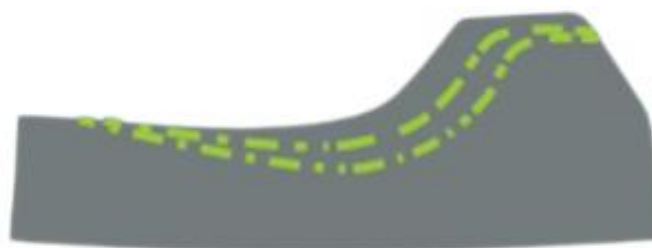
Рисунок 1.16 – Постоянство высоты выступа футеровки компании « Christian Pfeiffer »
