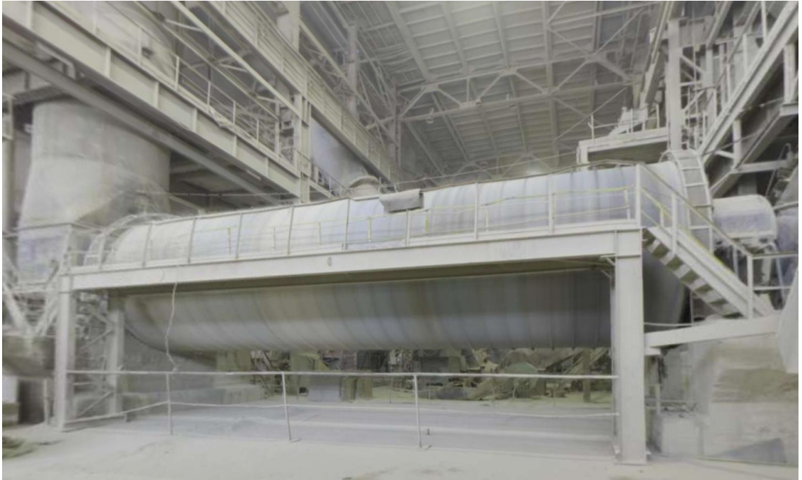
Рисунок 6.2 – Помольный агрегат с трубной шаровой мельницей \text{Ø}4 \times 13,5 м
